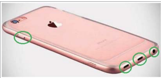
手机侧孔、槽尺寸测量
