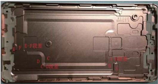
机加工件各台阶面的段差测量
